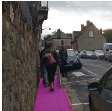
Devant la maternelle : le trottoir côté école est étroit et délimité par une barrière, on ne se croise pas. Côté opposé, le trottoir est occupé par des véhicules en stationnement. Le passage piéton en grande partie effacé est masqué par les véhicules en stationnement des deux côtés
